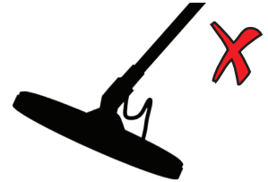
زاویه سیم پیچ جستجو اشتباه است
