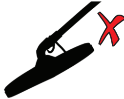
زاویه سیم پیچ جستجو اشتباه است
